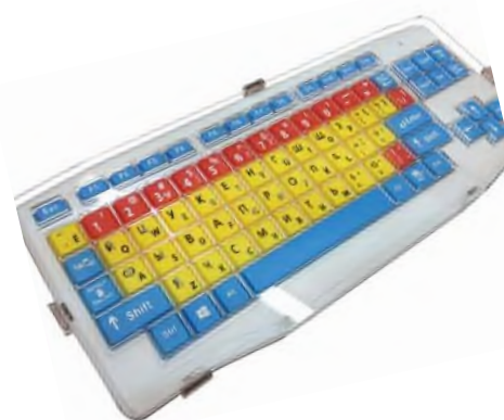
Клавиатура адаптированная с крупными кнопками + пластиковая накладочка, разделяющая клавиши
